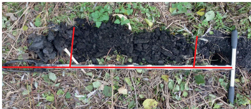
Obr. 3.94. Fluviálno-organogénne piesčito-siltovité tmavohnedé až čierne hliny (20 – 80 cm) v sonde bývalej inundačnej zóny Dunaja na JV od Kľúčovca. Humózne hliny prechádzajú nadol do tmavosivých plastických ílov (80 – 100 cm) (foto J. Maglay, 2016).
