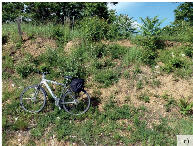
Obr. 3.16. Polymiktné, mierne zahlinené piesčité štrky strednej terasy vo výkopovej jame medzi Račianskou ulicou a bývalou stanicou Bratislava-Filiálka; a) detail zahlinených hrdzavohnedých piesčitých štrkov v odkryve; b) detail dažďom preplavených štrkov z odkryvu; c) časť umelého odkryvu vo výkopovej jame (foto J. Maglay, 2015).
