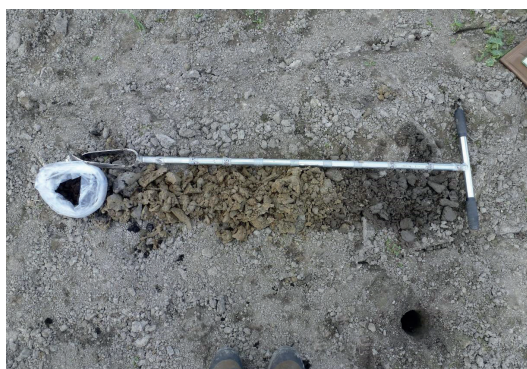
Obr. 3.62. Tmavosivé hnílokalové hliny až čierne humolity (vzorka vľavo) v podloží sivožltých piesčitých siltov „jadra“ Žitného ostrova v dne starého voľného ramena na S od Veľkej Paky (foto J. Maglay, 2016).
