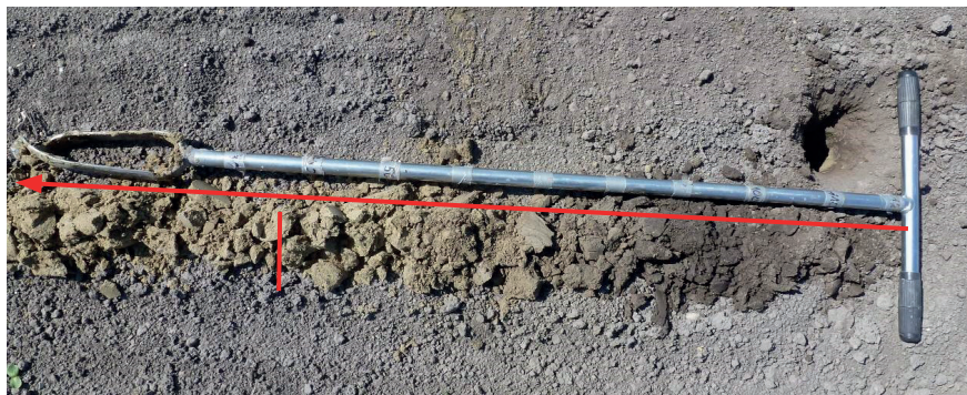
Obr. 3.72. Povodňové silty holocénneho nivného pokryvu v celom profile jednej z mnohých ručne vŕtaných sond pri Trsticiach. Vpravo je odčlenený hlinitý horizont recentnej pôdy (foto J. Maglay, 2016).
