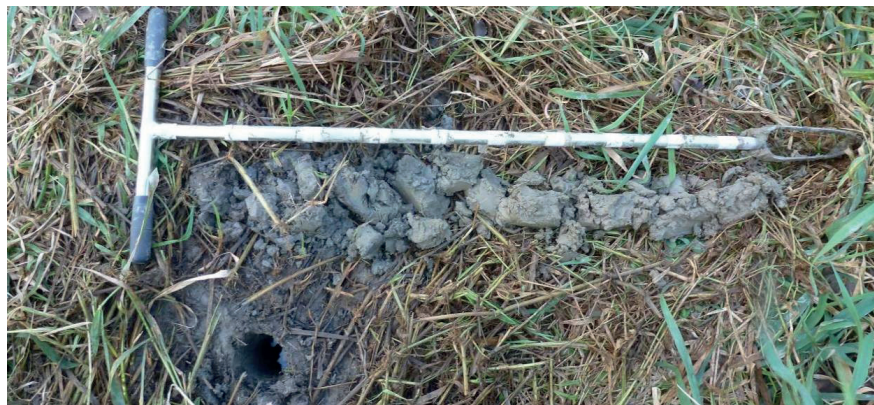
Obr. 3.93. Fluviálne sivomodré íly (0 – 40 cm) prechádzajúce do sivých piesčitých siltov až pieskov (40 – 100 cm) v sonde z inundačného územia Dunaja pri Bodíkoch. Istou zvláštnosťou je prítomnosť mladých holocénnych ílov v nadloží siltov a pieskov. Výnosu jadra z pieskov v spodnej časti zamedzila podzemná voda (foto J. Maglay, 2014).
