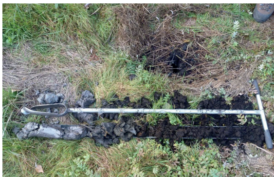
Obr. 3.84. Sivomodré, vysoko plastické íly v podloží plytkých hnedočiernych až čiernych rašelinových hlin a humózných slatinných pôd v rašelinisku Líščie diery pri Made (foto J. Maglay, 2016).
