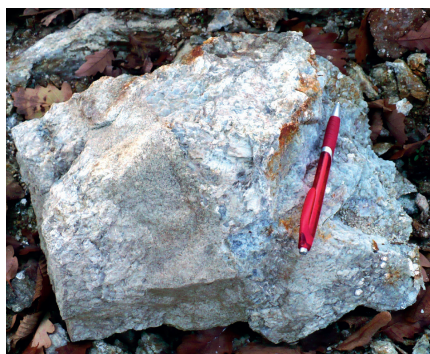
Obr. 3.6. a) Hrubozrnný muskovitický pegmatit na ostrom kontakte s granitom (výkop rodinného domu, Pekná cesta); b) živcová pegmatitová tavenina s výrastlicami biotitu uzatvárajúca vysokoteplotne prehnetené zvyšky sivého granitu (stavebné práce sv. od železničného depa v Bratislave).
