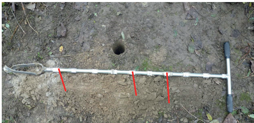
Obr. 3.90. Fluvialne jemnopiesčité sily mladoholocénneho náplavu Dunaja v blízkosti toku pri Bodíkoch. V intervale 0 – 30 cm je recentná pôda s difúznym prechodom (30 – 50 cm) do sivohnedých siltov (50 – 90 cm). V podloží siltov vystupujú svetlosivé piesky (90 – 120 cm) (foto J. Maglay, 2014).
