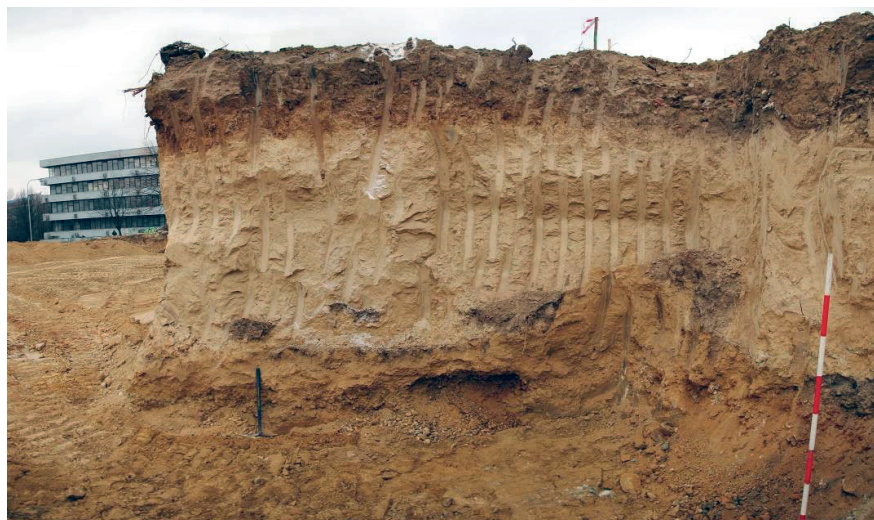
Obr. 3.18. Hrdzavohnedé piesčité štrky vyššej strednej terasy s pokryvom hlinito-piesčitých splachov, eolických spraší a antropogénnej navážky vo výkope základovej jamy v areáli Prírodovedeckej fakulty v Bratislave (foto M. Šujan, 2014).
