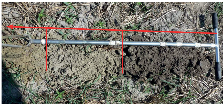
Obr. 3.67. Sonda v poli pri Dolných Salibách je jednou z mnohých sond so sledom: hlina (recentná pôda) – vápnitý silt až vápnitý jemnopiesčitý silt – siltovitý piesok až piesok, na mape označený indexom (19) (foto K. Fordinál, 2016).
