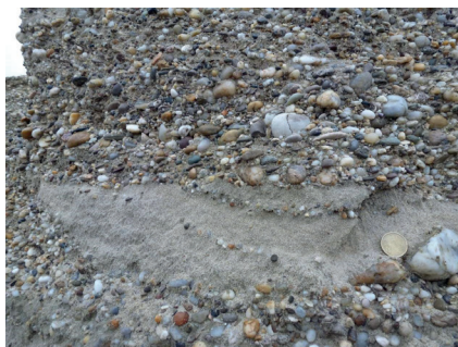
Obr. 3.52. Šošovky strednozrnných pieskov v semioválnych až oválnych piesčitých štrkoch spodnej časti vrchného komplexu akumulácie „jadra“ Žitného ostrova v štrkovni Zelená voda medzi Ivankou pri Dunaji a Mostom pri Bratislave (foto J. Maglay, 2014).
