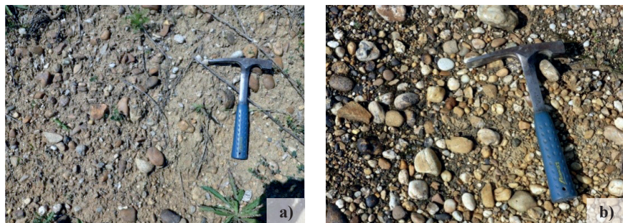
Obr. 3.16. Polymiktné, mierne zahlinené piesčité štrky strednej terasy vo výkopovej jame medzi Račianskou ulicou a bývalou stanicou Bratislava-Filiálka; a) detail zahlinených hrdzavohnedých piesčitých štrkov v odkryve; b) detail dažďom preplavených štrkov z odkryvu; c) časť umelého odkryvu vo výkopovej jame (foto J. Maglay, 2015).
