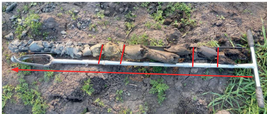
Obr. 3.76. Príklad najčastejšieho sledu holocéennej fluválnej akumulácie v miestach s výskytom ílov zo sondy v poli na V od Topoľník: 0 – 15 cm – recentná pôda, 15 – 28 cm – tmavosivý nevápnitý silt, 28 – 60 cm – sivohnedý ílovitý silt, 60 – 72 cm – svetlosivohnedý siltovitý íl s prímесou jemnozrnného piesku, 72 – 120 cm – sivomodrý plastický íl (foto J. Maglay, 2015).
