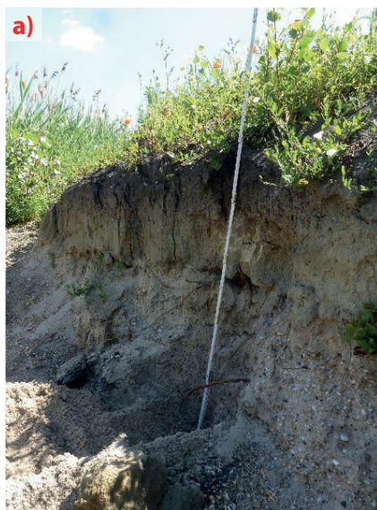
Obr. 3.68. Ukážky najčastejších foriem pozície a výstupov piesčitých štrkov holocénu v rámci regiónu: a) pozícia pod tenkou vrstvou piesčitých siltov v odkryve pri Boheľove; b) pozícia priamo pod recentným pôdnym pokryvom vo výkope základovej jamy v Gabčíkove; c) výstupy po odstránení hlinitej skrývky na brehu štrkovne v Trávniku s ukážkou recentnej abrázie brehu (foto J. Maglay, 2016).
