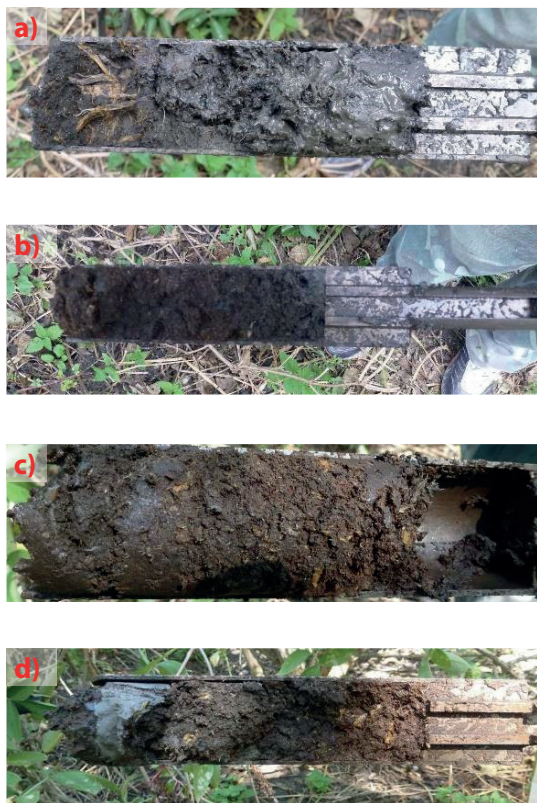
Obr. 3.66. Rastlinné humolity a humózne rašelinové hliny v jadre ručne vŕtanej sondy z výplne mŕtveho ramena pri obci Lúč na Ostrove:
