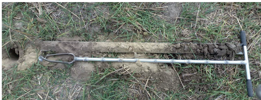
Obr. 3.71. Veľmi jemnozrnné svetlosivé fluválne piesky povodňovej fácie pod vrstvou recentnej pôdy hrubou 40 cm prechádzajú do strednozrnných sivých fluválnych pieskov s obsahom organickej hmoty vo výnose ručne vrtanej sondy na SV od Trhovej Hradskej (foto J. Maglay, 2016).
