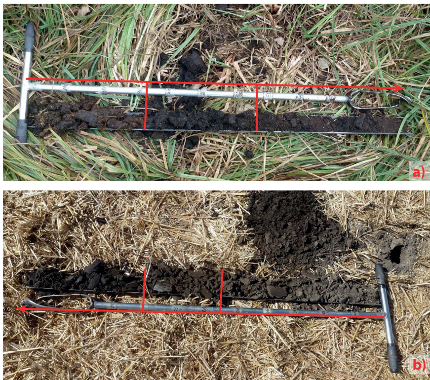
Obr. 3.77. Príklady vrchných častí sledu holocénných fluvjálno-organogénnych akumulácií zachytených sondami: a) v tesnej blízkosti rezervácie Čičovského ramena pri Čičove: 0 – 30 cm – recentná hlinito-ílovitá pôda (organozem) so zvyškami koreňového rastlinného systému, 30 – 65 cm – tmavosivý až čierny ílovito-hlinitý humolit so zvyškami nedostatočne rozloženej organickej hmoty, 65 – 120 cm – hnedosivý siltový humolit s tenkými preplástkami ílov; b) v poli na rozsiahlejšej zníženine pri Vrakúni: 0 – 55 cm – tmavosivá recentná siltovito-piesčitá pôda, 55 – 80 cm – tmavosivohnedý ílovitý silt s organickou hmotou s prímiesou jemnozrnného piesku, 80 – 120 cm – tmavosivý až čierny ílovito-siltový hnilokal (foto J. Maglay, 2014).
