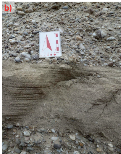
Obr. 3.53. Tenké vrstvy strednozrnných pieskov (miestami aj štrkovitých pieskov) v hrubších vrstvách piesčitých štrkov spodnej časti vrchného komplexu akumulácie „jadra“ Žitného ostrova vo výkope kanalizačného zvodu v Kvetoslavove: a) – striedanie nesúvislých subhorizontálnych vrstiev pieskov a piesčitých štrkov vo vrchnej časti súvrstvia; b) – detail piesčitej vrstvy (foto J. Maglay, 2015).
